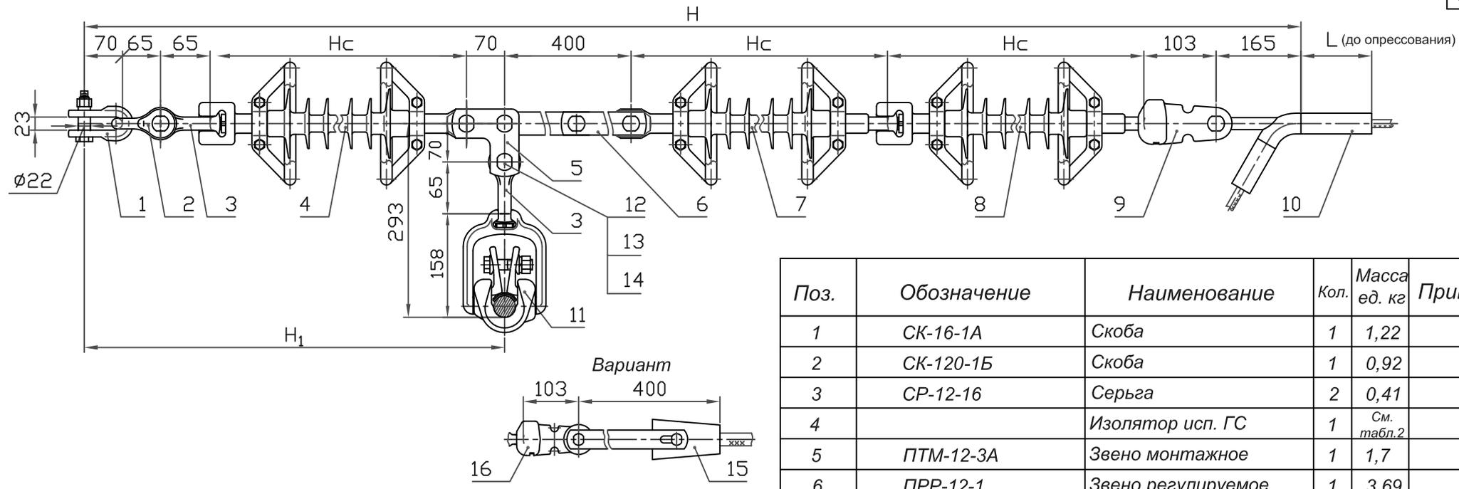
1. При заказе натяжного клинового зажима типа НК (см.табл.7, стр.16) (поз.15) следует указывать марку провода. Ушко У2-12-16 (поз.9) заменить на У1-12-16 (поз.16).
