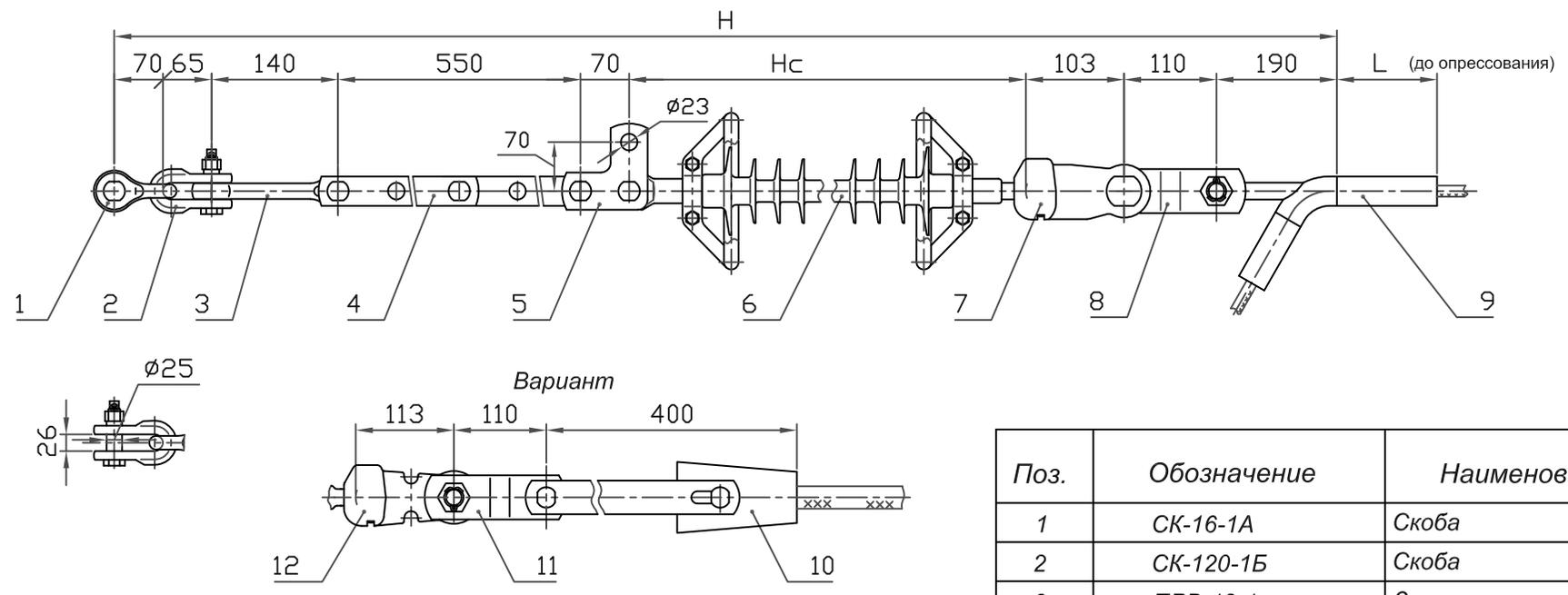
При заказе натяжного клинового зажима типа НК (см.табл.7, стр.16) следует указывать марку провода. Ушко У2-16-20 (поз.7) заменить на У1-16-20 (поз.12), а звено ПРТ-16/12-2 (поз. 8) на ПРТ-12/16-2 (поз.11).
