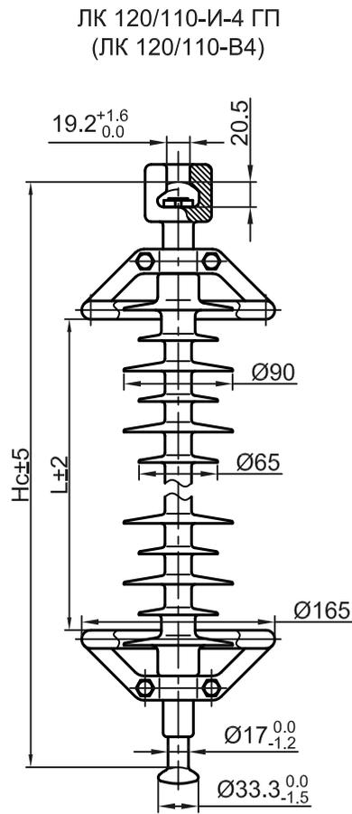
Типы оконцевателей на класс разрушающей нагрузки 70 кН
