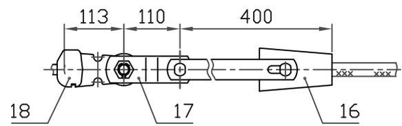
1. При заказе натяжного клинового зажима типа НК (см.табл.7, стр.16) (поз.16) следует указывать марку провода. Ушко У2-16-20 (поз.8) заменить на У1-16-20 (поз.18), а звено ПРТ-16/12-2 (поз.8) на ПРТ-12/16-2 (поз.17).
