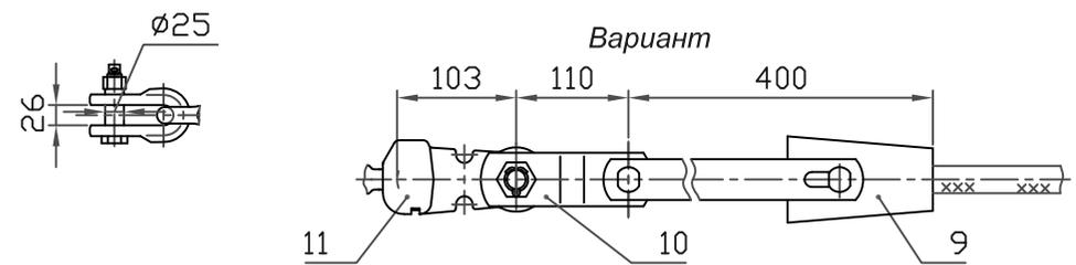
При заказе натяжного клинового зажима типа НК (см.табл.7, стр.16) следует указывать марку провода. Ушко У2-16-20 (поз.6) заменить на У1-16-20 (поз.11), а звено ПРТ-12/16-2 (поз.7) на ПРТ-16/12-2 (поз.10).
