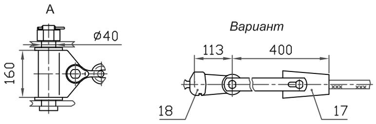
1. При заказе натяжного клинового зажима типа НК (см.табл.7, стр.16) (поз.17) следует указывать марку провода. Ушко У2-16-20 (поз.9) заменить на У1-16-20 (поз.18).
