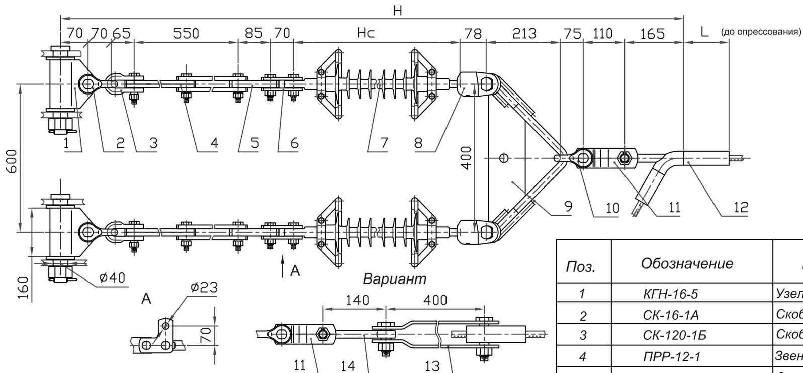
1. При заказе натяжного клинового зажима типа НК (см. табл.7, стр.16) (поз.13) следует указывать марку провода. В спецификацию добавляется ПРВ-12-1 (поз.14).
