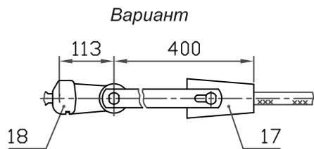
1. При заказе натяжного клинового зажима типа НК (см.табл.7, стр.16) (поз.17) следует указывать марку провода. Ушко У2-16-20 (поз.9) заменить на У1-16-20 (поз.18).
