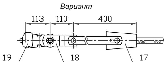
1. При заказе натяжного клинового зажима типа НК (см.табл.7, стр.16) (поз.17) следует указывать марку провода. Ушко У2-16-20 (поз.8) заменить на У1-16-20 (поз.19), а звено ПРТ-12/16-2 (поз.11) на ПРТ-16/12-2 (поз.18).
