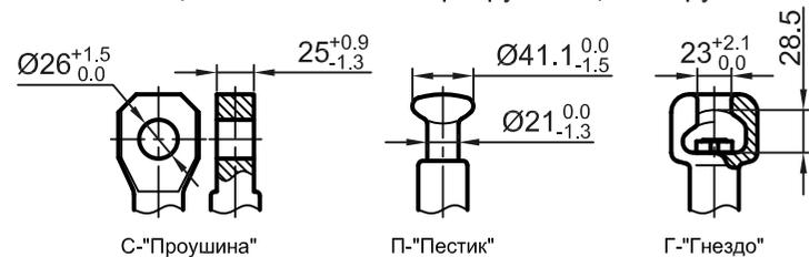
Типы оконцевателей на класс разрушающей нагрузки 210 кН
