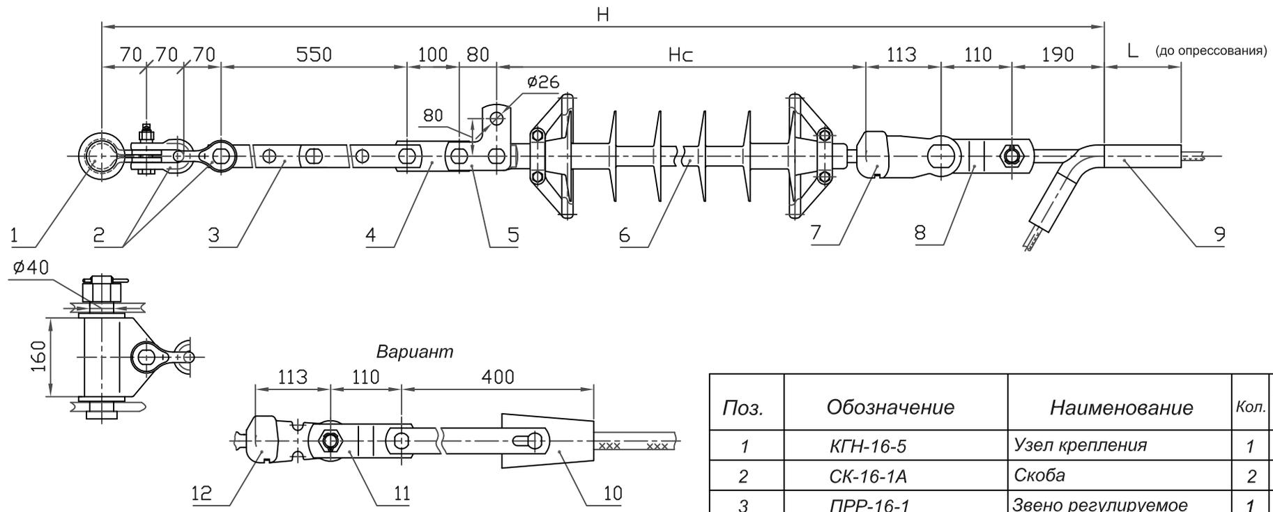
При заказе натяжного клинового зажима типа НК (см.табл.7, стр.16) следует указывать марку провода. Ушко У2-16-20 (поз.7) заменить на У1-16-20 (поз.12), а звено ПРТ-16/12-2 (поз. 8) на ПРТ-12/16-2 (поз.11).
