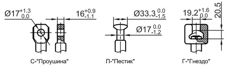
Типы оконцевателей на класс разрушающей нагрузки 120 кН
