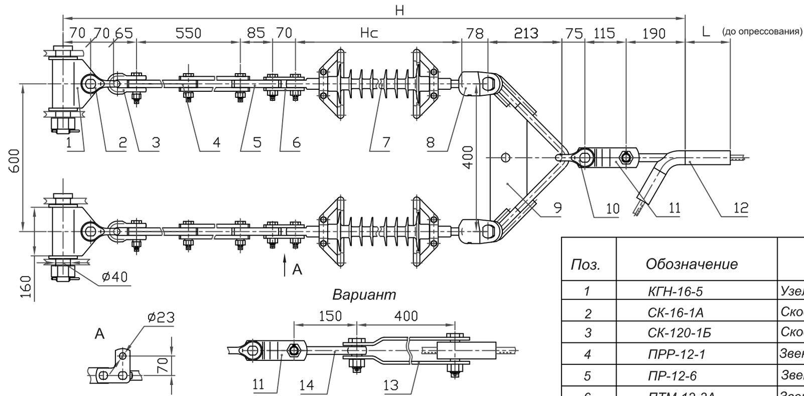
1. При заказе натяжного клинового зажима типа НК (см.табл.7, стр.16) (поз.13) следует указывать марку провода. В спецификацию добавляется ПРВ-16-1 (поз.14).
