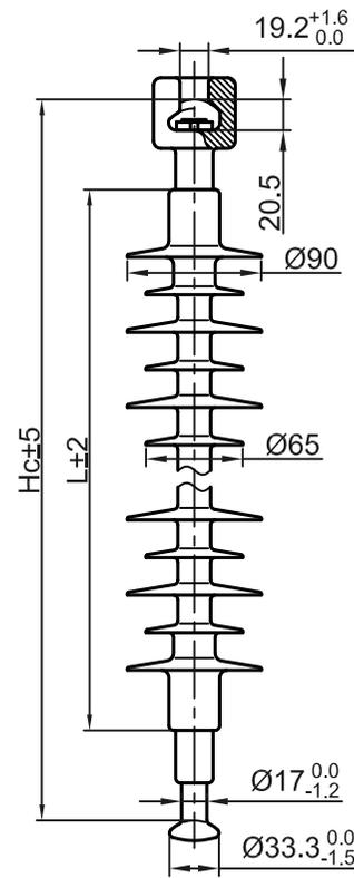
Типы оконцевателей на класс разрушающей нагрузки 70 кН
