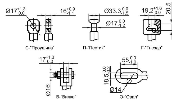
Типы оконцевателей на класс разрушающей нагрузки 120 кН
