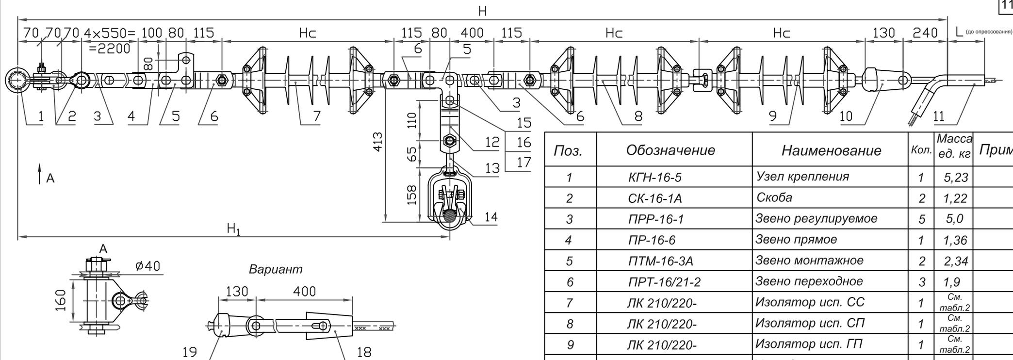
1. При заказе натяжного клинового зажима типа НК (см.табл.7, стр.16) (поз.18) следует указывать марку провода. Ушко У2-21-20 (поз.10) заменить на У1-21-20 (поз.19).
