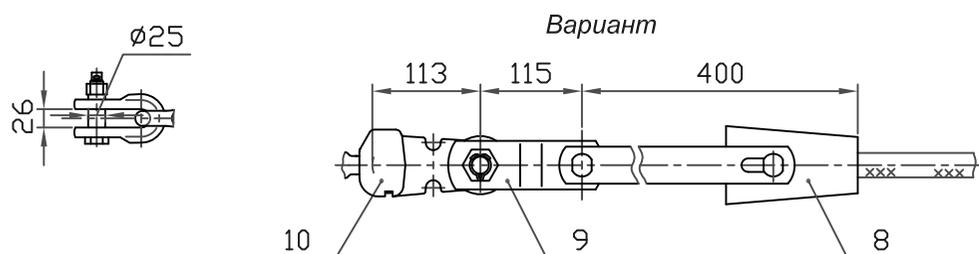
При заказе натяжного клинового зажима типа НК (см.табл.7, стр.16) следует указывать марку провода. Ушко У2-16-20 (поз.6) заменить на У1-16-20 (поз.11), а звено ПРТ-16/21-2 (поз.7) на ПРТ-21/16-2 (поз.10).
