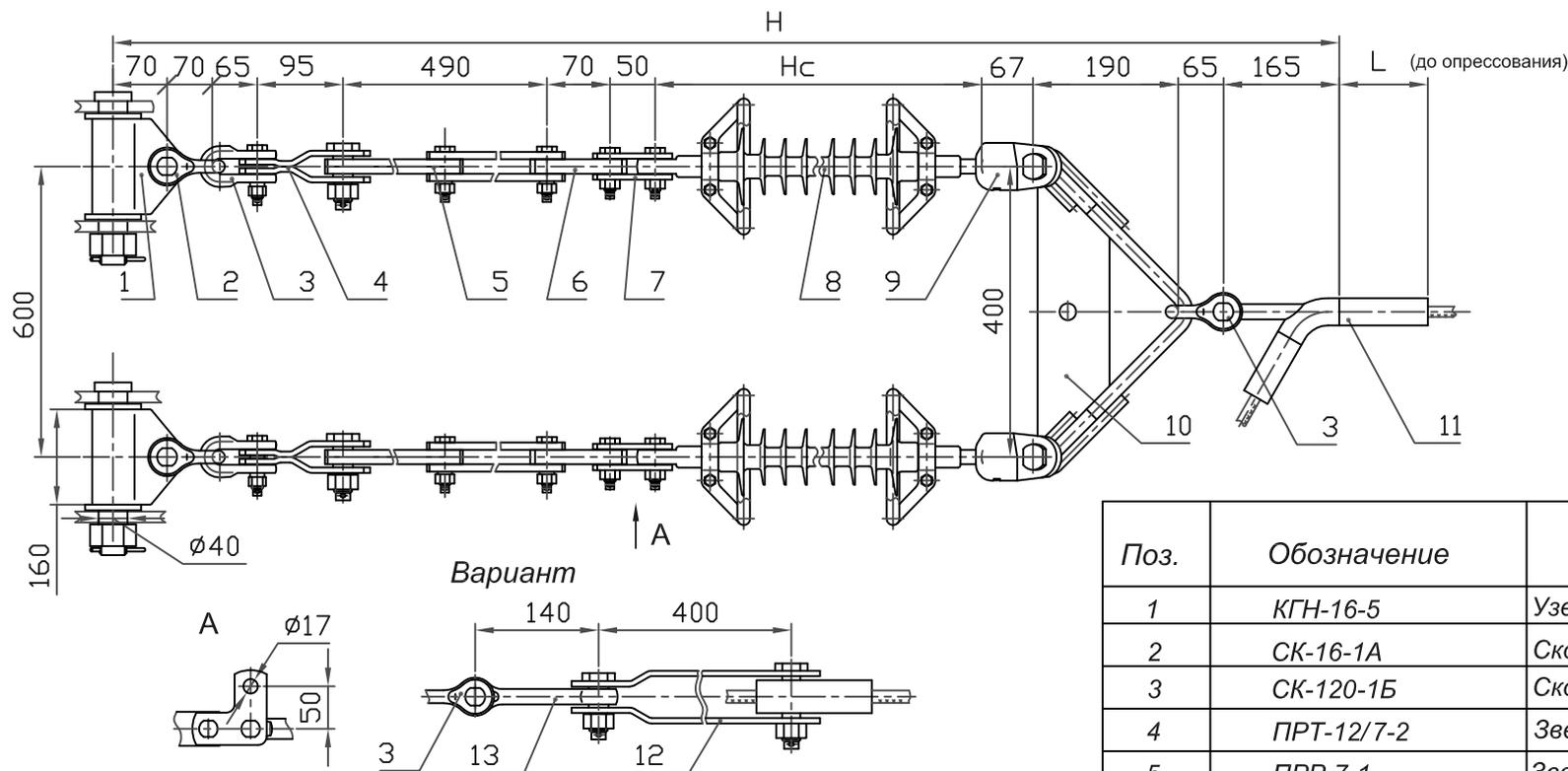
1. При заказе натяжного клинового зажима типа НК (см.табл.7, стр.16) следует указывать марку провода. В спецификацию добавляется ПРВ-12-1 (поз.13).
