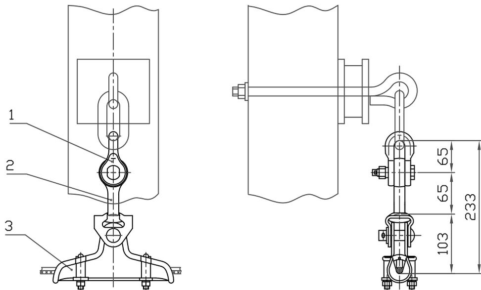
Вариант крепления троса с заземлением
