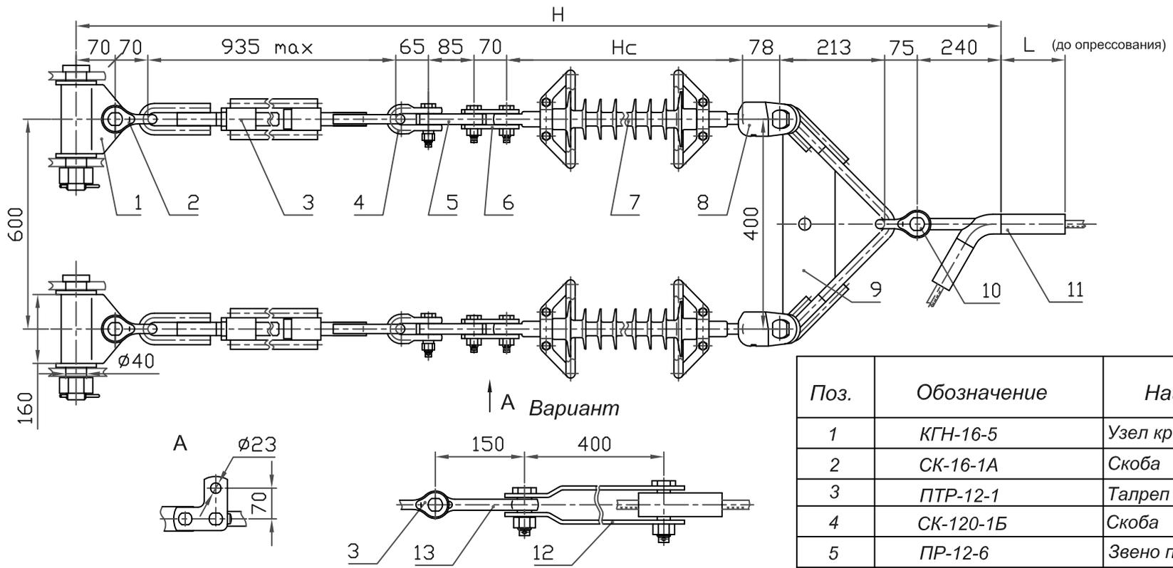
1. При заказе натяжного клинового зажима типа НК (см.табл.7, стр.16) (поз.12) следует указывать марку провода. В спецификацию добавляется ПРВ-21-1 (поз.13).
