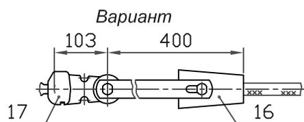
1. При заказе натяжного клинового зажима типа НК (см.табл.7, стр.16) (поз.16) следует указывать марку провода. Ушко У2-12-16 (поз.10) заменить на У1-12-16 (поз.17).
