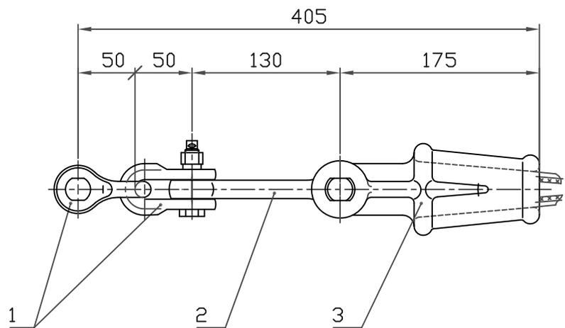
Вариант крепления троса с заземлением
