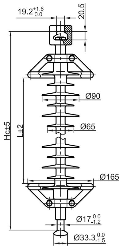
Типы оконцевателей на класс разрушающей нагрузки 70 кН
