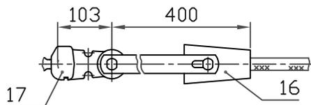
1. При заказе натяжного клинового зажима типа НК (см. табл.7, стр.16) (поз.16) следует указывать марку провода. Ушко У2-12-16 (поз.10) заменить на У1-12-16 (поз.17).
