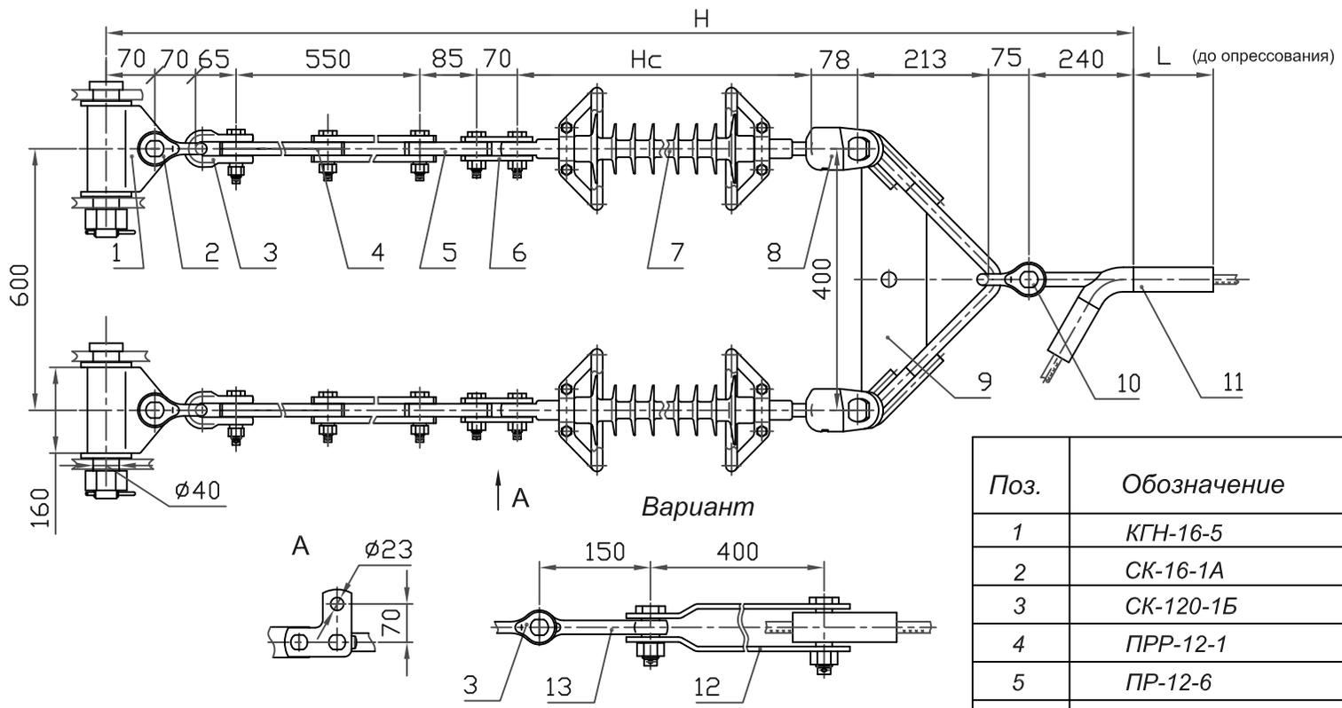
1. При заказе натяжного клинового зажима типа НК (см.табл.7, стр.16) (поз.12) следует указывать марку провода. В спецификацию добавляется ПРВ-21-1 (поз.13).
