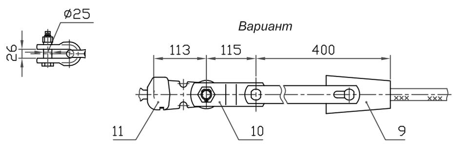
При заказе натяжного клинового зажима типа НК (см.табл.7, стр.16) следует указывать марку провода. Ушко У2-16-20 (поз.6) заменить на У1-16-20 (поз.11), а звено ПРТ-16/21-2 (поз.7) на ПРТ-21/16-2 (поз.10).
