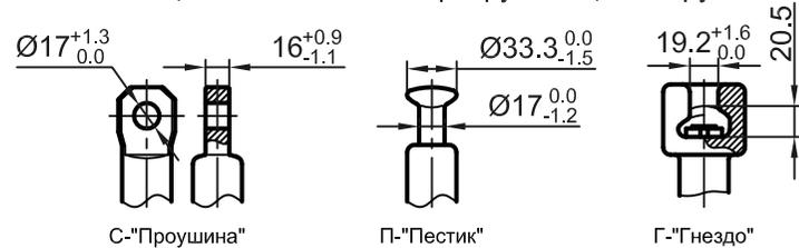
Типы оконцевателей на класс разрушающей нагрузки 120 кН
