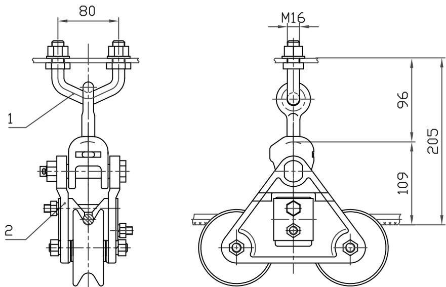
Вариант крепления троса с заземлением
