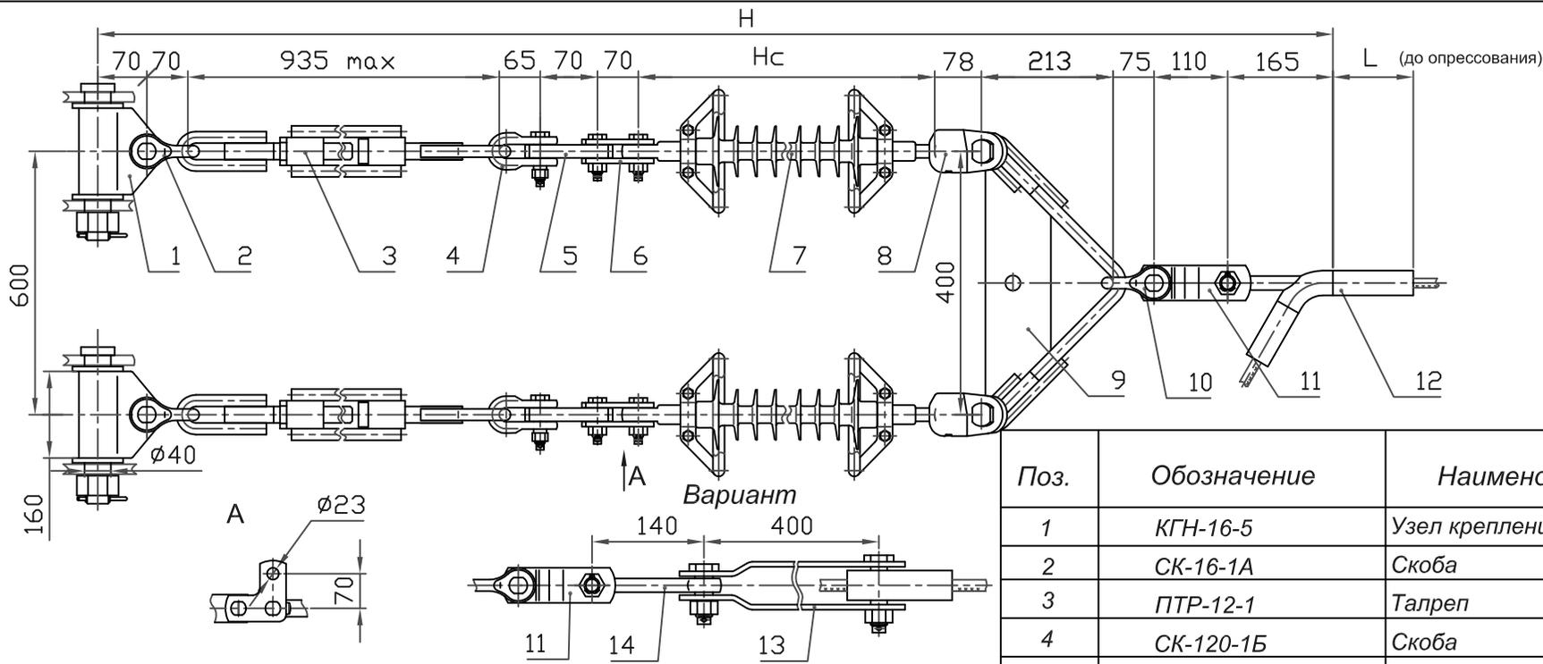
1. При заказе натяжного клинового зажима типа НК (см.табл.7, стр.16) (поз.13) следует указывать марку провода. В спецификацию добавляется ПРВ-12-1 (поз.14).
