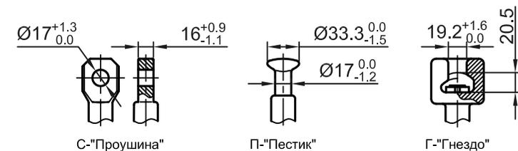
Типы оконцевателей на класс разрушающей нагрузки 120 кН
