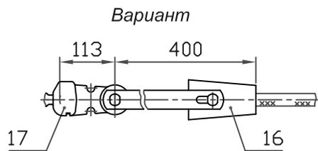
1. При заказе натяжного клинового зажима типа НК (см.табл.7, стр.16) (поз.16) следует указывать марку провода. Ушко У2-16-20 (поз.8) заменить на У1-16-20 (поз.17).
