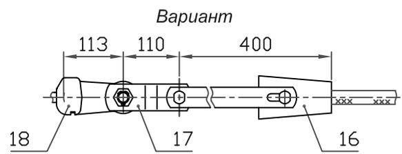
1. При заказе натяжного клинового зажима типа НК (см.табл.7, стр.16) следует указывать марку провода. Ушко У2-16-20 (поз.8) заменить на У1-16-20 (поз.18), а звено ПРТ-16/12-2 (поз.9) на ПРТ-12/16-2 (поз.17).
