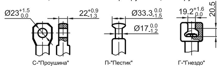
Типы оконцевателей на класс разрушающей нагрузки 160 кН
