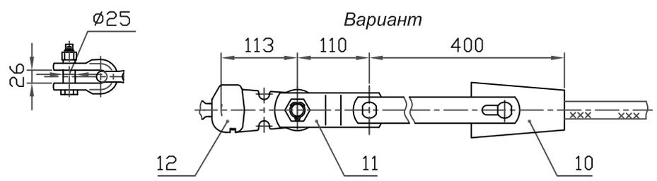
При заказе натяжного клинового зажима типа НК (см.табл.7, стр.16) следует указывать марку провода. Ушко У2-16-20 (поз.7) заменить на У1-16-20 (поз.12), а звено ПРТ-16/12-2 (поз. 8) на ПРТ-12/16-2 (поз.11).
