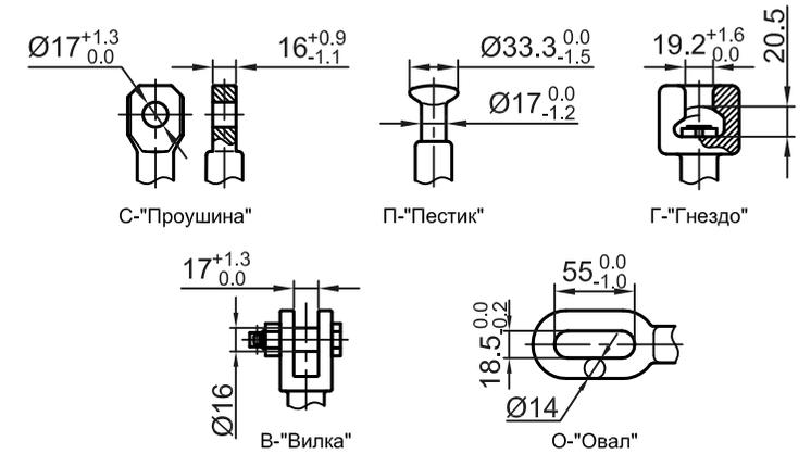
Типы оконцевателей на класс разрушающей нагрузки 120 кН
