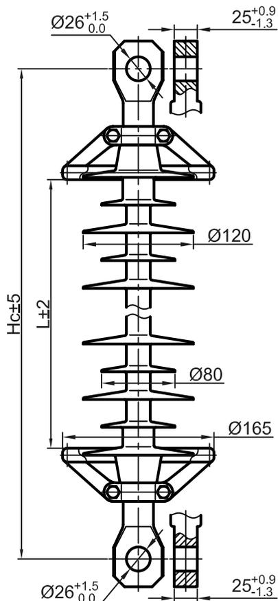
Типы оконцевателей на класс разрушающей нагрузки 70 кН
