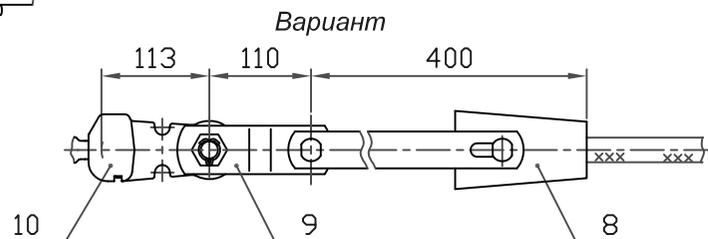
При заказе натяжного клинового зажима типа НК (см.табл.7, стр.16) следует указывать марку провода. Ушко У2-16-20 (поз.5) заменить на У1-16-20 (поз.10), а звено ПРТ-16/12-2 (поз. 6) на ПРТ-12/16-2 (поз.9).
