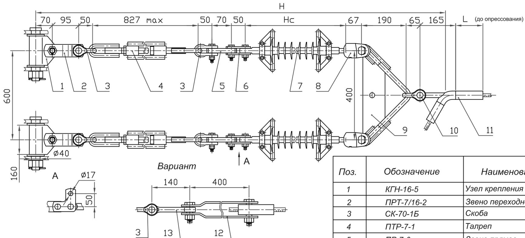
1. При заказе натяжного клинового зажима типа НК (см.табл.7, стр.16) следует указывать марку провода. В спецификацию добавляется ПРВ-12-1 (поз.13).
