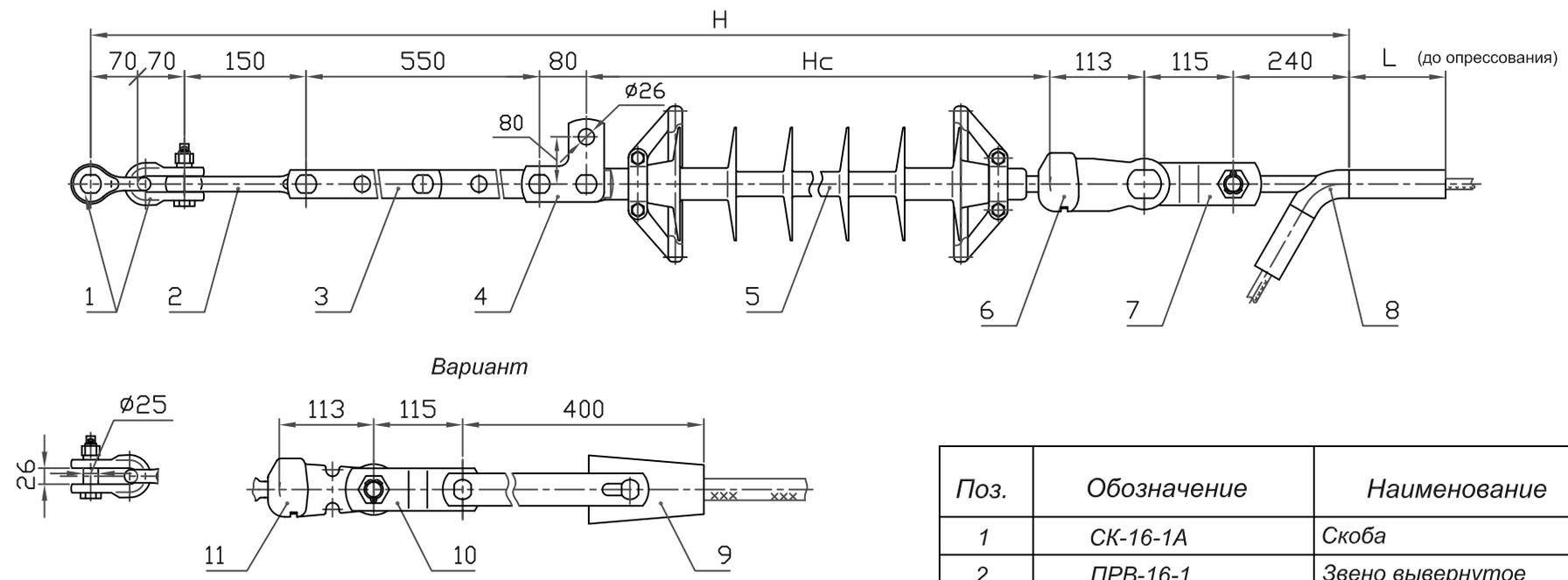
При заказе натяжного клинового зажима типа НК (см.табл.7, стр.16) следует указывать марку провода. Ушко У2-16-20 (поз.6) заменить на У1-16-20 (поз.11), а звено ПРТ-16/21-2 (поз.7) на ПРТ-21/16-2 (поз.10).
