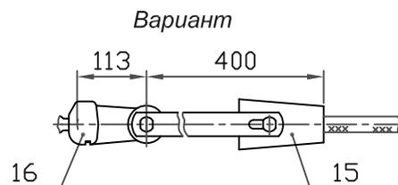
1. При заказе натяжного клинового зажима типа НК (см.табл.7, стр.16) (поз.15) следует указывать марку провода. Ушко У2-16-20 (поз.7) заменить на У1-16-20 (поз.16).
