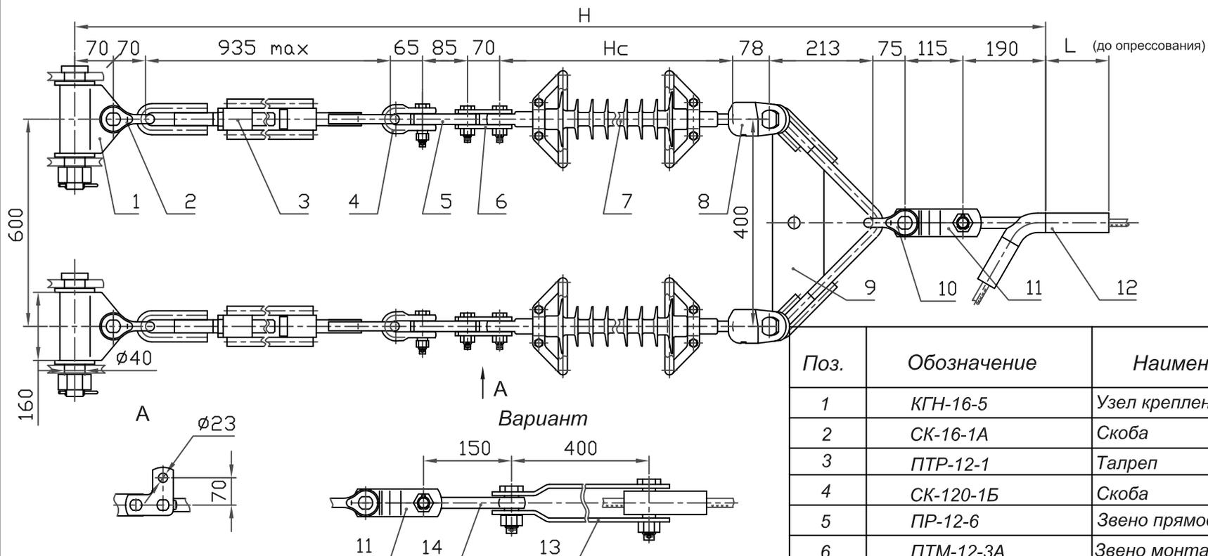
1. При заказе натяжного клинового зажима типа НК (см.табл.7, стр.16) (поз.13) следует указывать марку провода. В спецификацию добавляется ПРВ-16-1 (поз.14).
