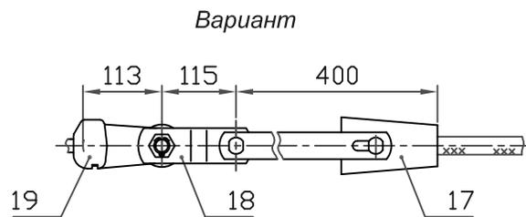
1. При заказе натяжного клинового зажима типа НК (см.табл.7, стр.16) (поз.17) следует указывать марку провода. Ушко У2-16-20 (поз.8) заменить на У1-16-20 (поз.19), а звено ПРТ-16/21-2 (поз.9) на ПРТ-21/16-2 (поз.18).
