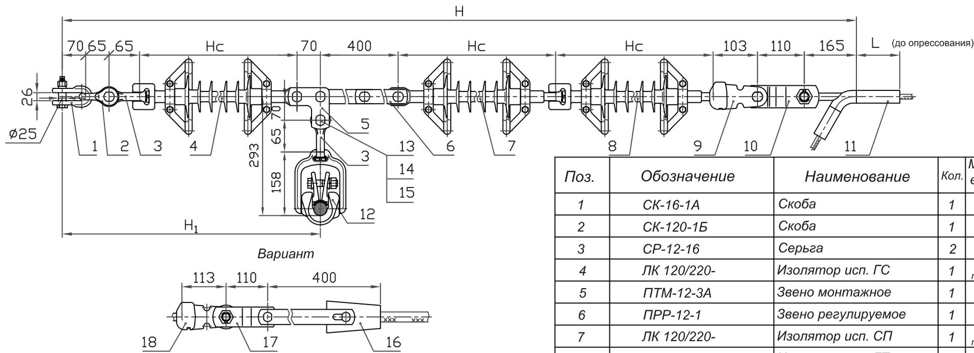
1. При заказе натяжного клинового зажима типа НК (см.табл.7, стр.16) следует указывать марку провода. Ушко У2-16-20 (поз.9) заменить на У1-16-20 (поз.18), а звено ПРТ-12/16-2 (поз.9) на ПРТ-16/12-2 (поз.17)..
