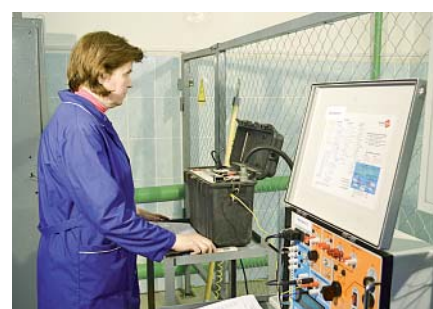
Испытания на электрическую прочность ответвительных прокалывающих зажимов, с полным погружением в воду
